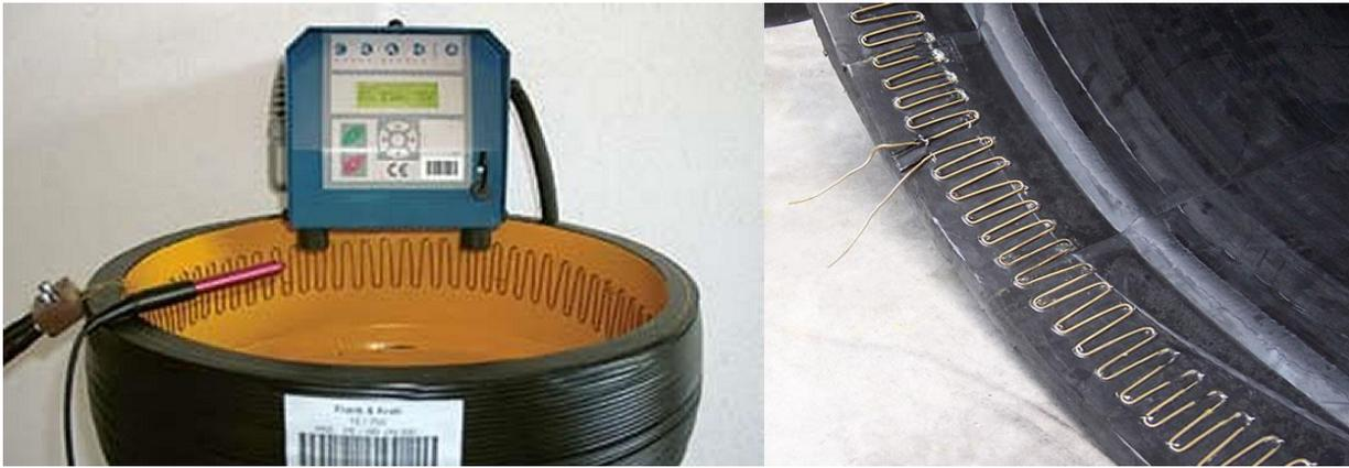
Рис. 5. Расположение спиральной проволоки при электрофузионной сварке.
