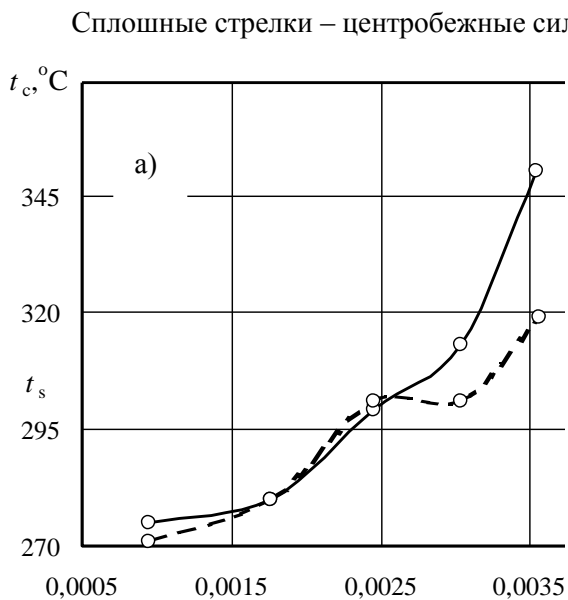
Рис.3 Зависимость изменения температуры стенки от приведенной длины вертикально змеевиковой трубы.
